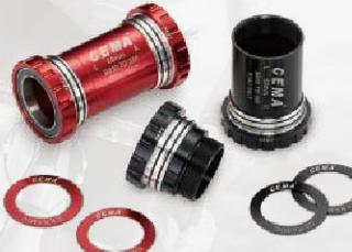
CEMA BB 中軸經精密CNC加工精確掌握尺寸與公差，搭載SRC輕量化低阻力培林，創新的中心對鎖式結構更能充分提高功率傳輸，並有效改善異音及龜裂問題，兩側防塵蓋設定讓安裝方便維護簡單
